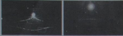
图3 光源靠近直线的情景 图4 光源远离直线的情景 图2的仿真结果表明，光源离直线越近，像的畸变越厉害。这和图3、图4呈现的实验结果符合得很好。
